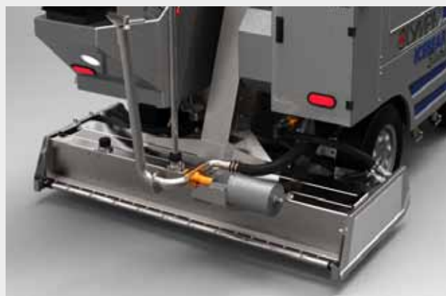
Vattenkanon. Separat kälkmonterad vattenkanon med kapacitet på upp till 350 liter per minut, steglöst reglerbar
